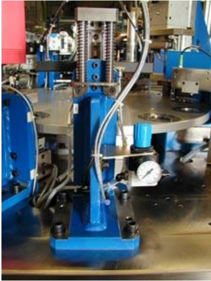
Prüfanlage für Koppelstangenlager
